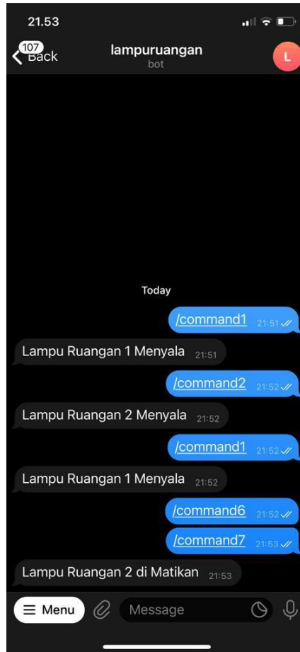
Gambar 4. 19 Tampilan Command Untuk Mematikan dan Menyalakan Lampu Ruangan
